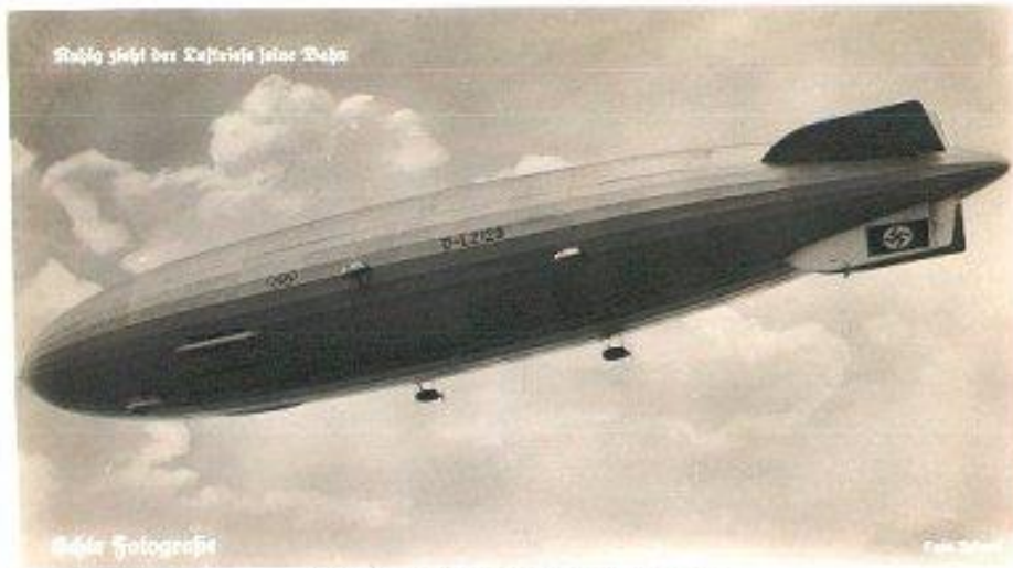
Das neue deutsche Zeppelin-Luftschiff L. Z. 129 Das größte Luftschiff der Welt. Länge 248 m., Höhe 46,7 m., größter Durchmesser 41,2 m. Vertriebsmaschinen: 4 Mercedes-Benz Dieselmotore von je 1900 PS, Geschwindigkeit von etwa 130 Meilen.
